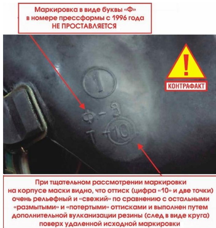
Рисунок 4.13. Пример контрафактной лицевой части противогаза ГП-7
